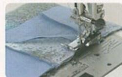
押さえのガイドに布端を合わせるだけで、布端から一定幅のピーシングができます。パッチワークがカンタンです。
